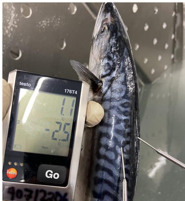
Figur 2 Temperaturmålinger med termometer (testo 176T4) med to temperaturfølere. Den ene føleren ble ført til kjernen (under ryggfinnen, ved ryggbeinet), mens den andre målte temperaturen cirka 1 mm under skinnen.
