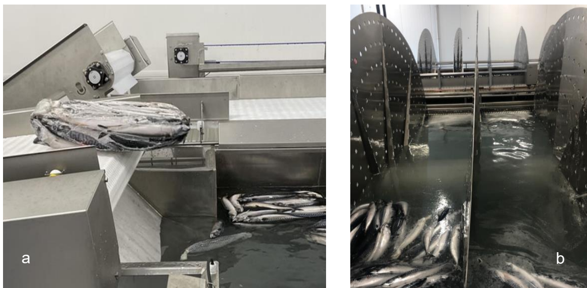
Figur 11 a) Innmating i tinetank. Makrell med logger (i stekenett) har løsnet fra blokka og ses under innløpet på tinetanken. b) Fordeling av fisk/blokker i tinetank
